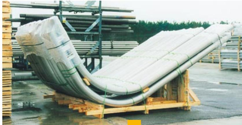
**Versandfertig verpackte Rohrbogen mit Schenkelverlängerungen**
