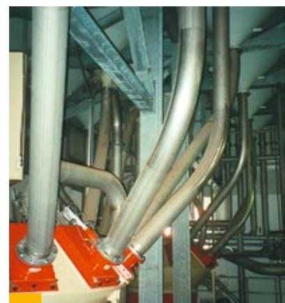
**Exakt auch in komplexen Rohrleitungssystemen – schlanke Bogen einer Kaffeeröstanlage für DARBOVEN in Hamburg**
