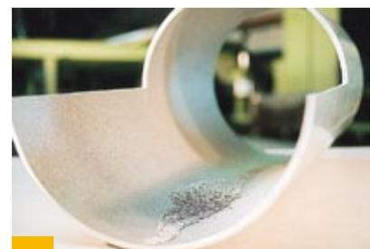
Aufgeraute und verdichtete Oberfläche durch Kugelstrahlen
