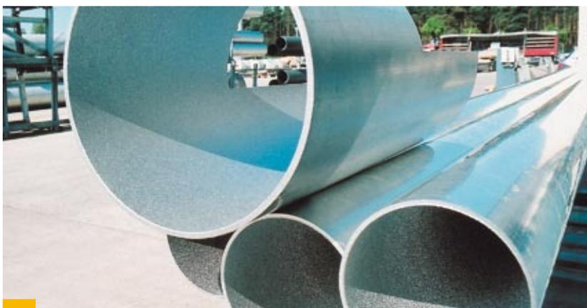
Pneumatikförderrohre mit kugelgestrahlten Innenoberflächen ermöglichen schonenden Schüttguttransport
