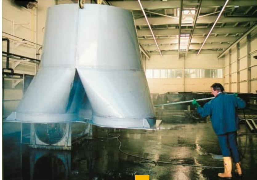
Reinigen eines Formteils in der Beize
