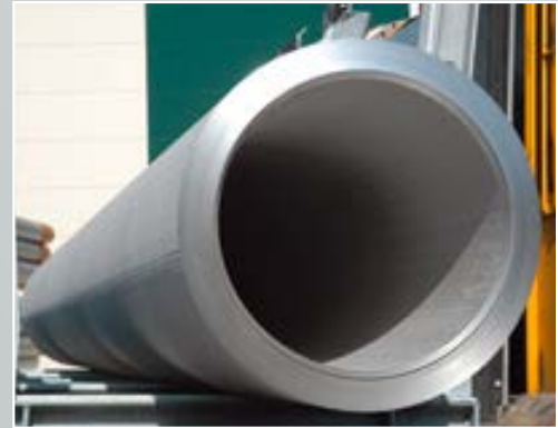
Blechtafeln werden eingekantet oder eingeformt und zu Rohren verschweißt
