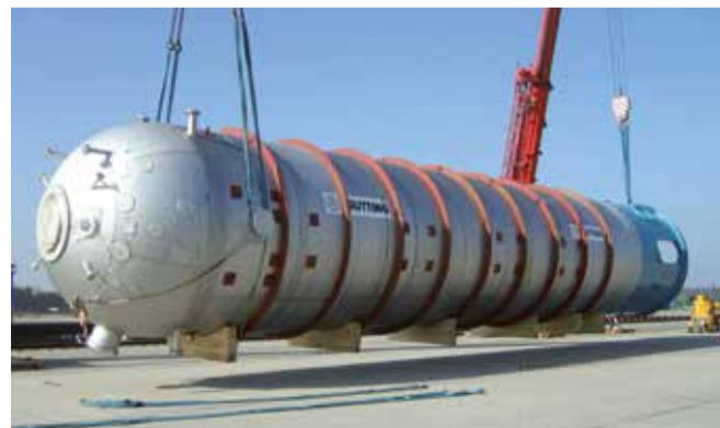
59-t-Druckbehälter aus Werkstoff 1.4162 für Südafrika
