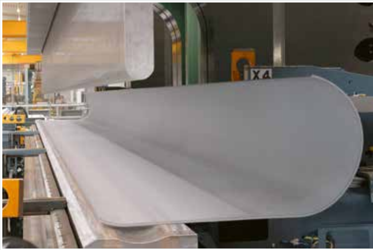
Blechtafeln werden eingekantet oder eingeformt und zu Rohren verschweißt
