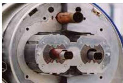
In der Mitte des Modells befinden sich die beiden Beam Screen Rohre umschlossen von Magneten. Der Magnet ist wiederum umschlossen von den LHC-Halbschalen
