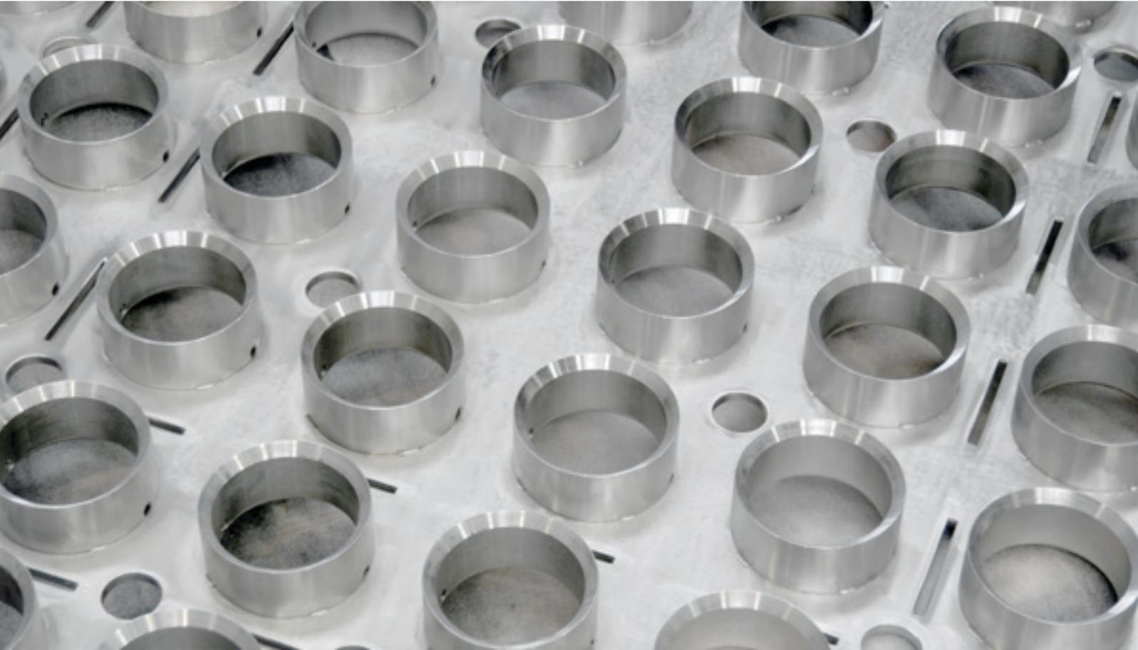
Sonderanfertigung einer Bodenplatte für einen Tragkorb
