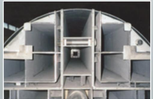
Modernste Schweißtechnik: mittels Lasertechnik geschweißte Vierkantschächte für die Nasslagerung
