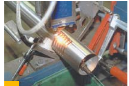
Bild 33: Mit dem Laser-Konturschnitt an einem Leuchtenkörper können alle Vorgaben umgesetzt werden
