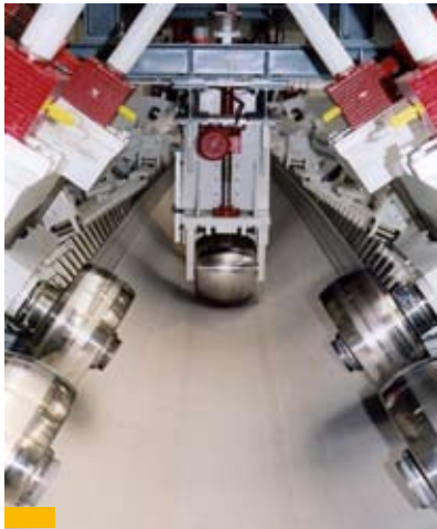
Bild 4: Die kontinuierliche Fertigung längsnahtgeschweißter Rohre ist ökonomisch vorteilhaft
