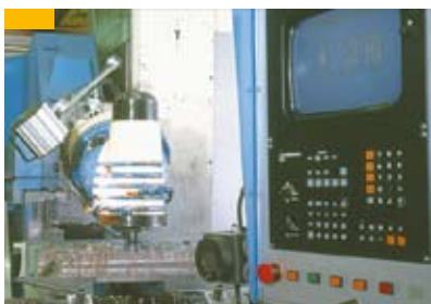
Bild 34: Zerspangung an einer CNC-Fräsmaschine zur Umsetzung exakter Maßvorgaben
