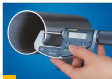
Bild 20: Messung der Wanddicke
