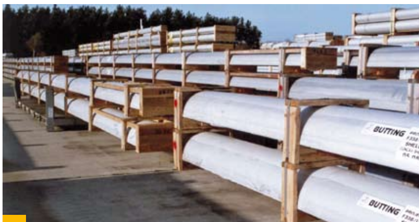
Bild 15: Lieferung für das Kernforschungszentrum CERN: 43 500 m LHC-Halbschalen mit einem Gewicht von 3 200 t
