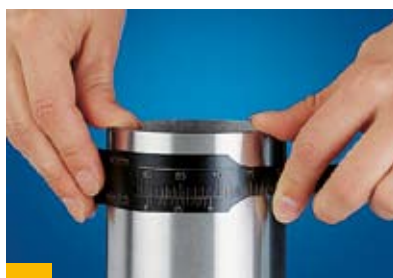
Bild 19: Messung des gemittelten Durchmessers
