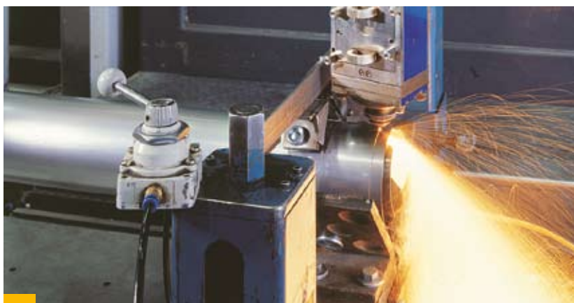
Bild 30: Thermisches Ablängen einer Rohrfixlänge an der Laseranlage
