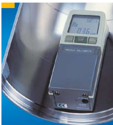
Bild 23: Rauheitsmessung an der Innenoberfläche
