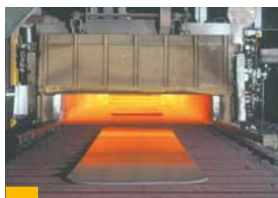
Bild 13: Wärmebehandlung im Ofen
