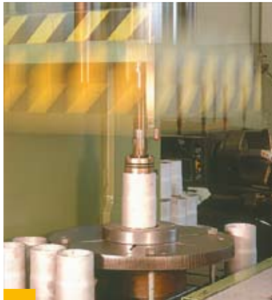
Bild 41: Innenkalibrierung ermöglicht exakte und reproduzierbare Rohrkomponenten
