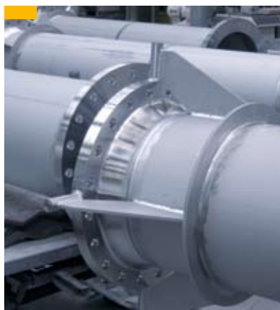
Bild 37: Fertigung von Steigrohren (Ø 508 x 9,53 x 3 000 mm) für die Brunnentechnik
