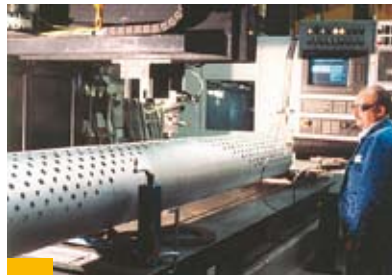
Bild 31: Mit einem Laser erzeugte Löcher für Filterrohre
