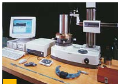
Bild 22: Messeinrichtung zur Prüfung von Rundheit und Parallelität
