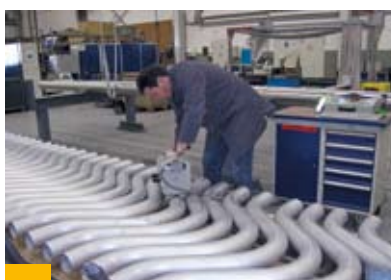
Bild 43: Etagenbogen für die Durchflussmessung werden gekennzeichnet
