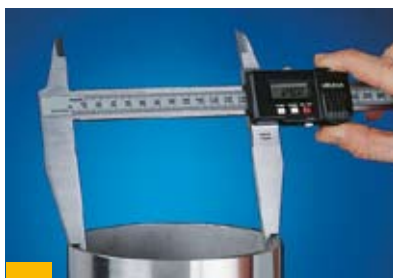
Bild 21: Messung der Rundheit/Ovalität (manuell)
