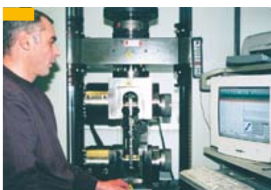
Bild 46: Burkhard Hirtz beim Zugversuch mit Feindehnungsmessung
