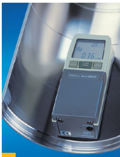
Rauheitsmessung an der Innenoberfläche von längsnahtgeschweißten Rohren
